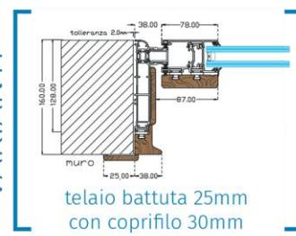
telaio battuta 25mm con coprifilo 30mm
